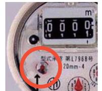
水道メーターには、パイロットと呼ばれるパーツがあります。通常、水を使用している場合はクルクルと回り、使用していない場合は止まっています。全ての蛇口を閉めている状態でもパイロットが回っている場合は、漏水していると判断できます。
