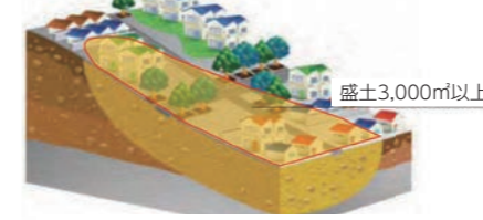
(谷埋め型大規模盛土造成地のイメージ)
