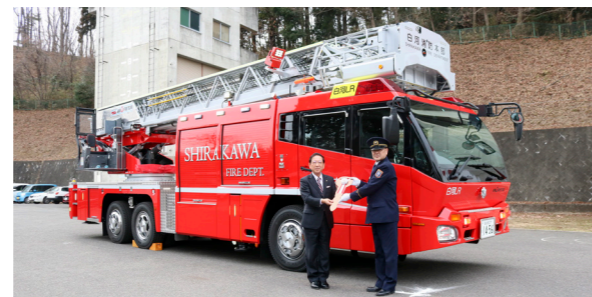
▲1分間に2,000ℓ放水する水路管を装備
