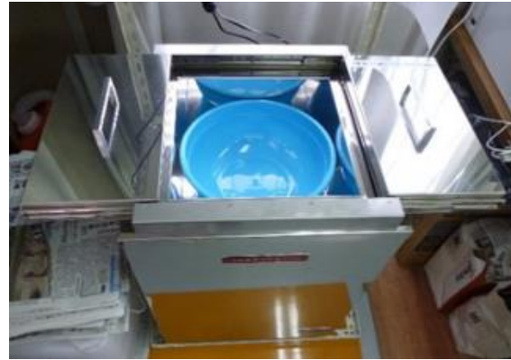
【非破壊式放射線測定装置】 食物の放射線量をそのまま測ることができる。
