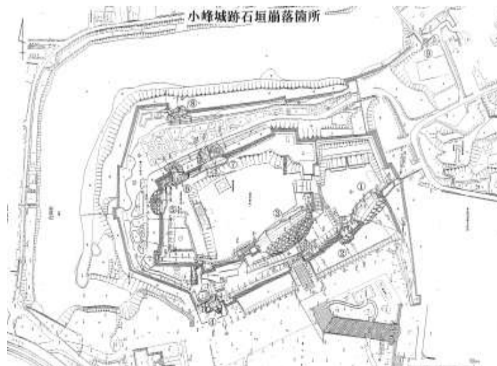
小峰城跡石垣崩落箇所
